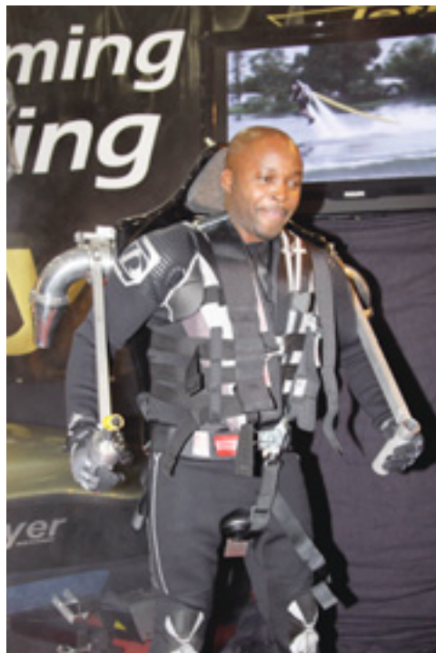
Der „JetLev-Flyer“ erlaubt unerreichte Fortbewegungen per Rückstoßprinzip
