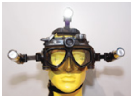
Die maximale Tauchtiefe wird mit 35 m angegeben – hier mit Beleuchtung
