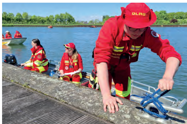
Längsseits anlegen während der praktischen Prüfung »Fahrpraxis«. Der Prüfling belegt eine Klampe zum Festmachen des Motorrettungsbootes.
