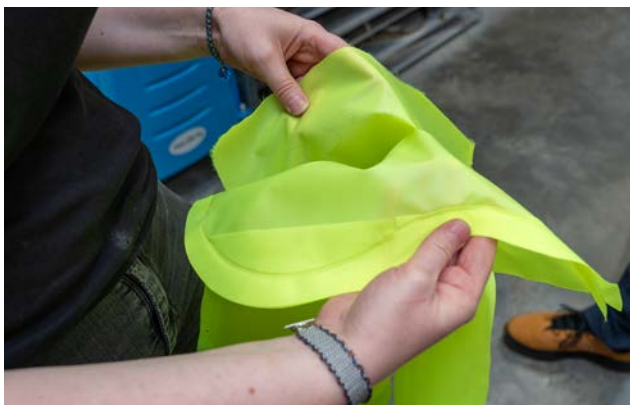
Nach dem Knall: Bei diesem Berstversuch hat die Schweißnaht gehalten.
