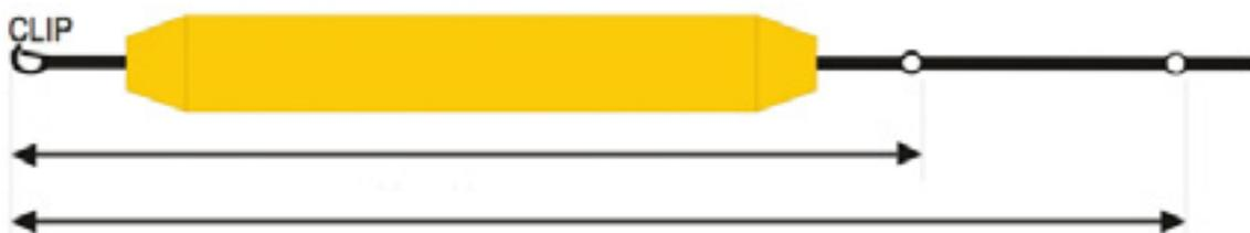
Strecke: 1. O-RING >>> Gurt:  $1,90\text{ m} - 2,10\text{ m}$ , einschließlich mindestens zweier O-Ringe
