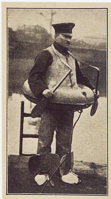
Luftgefüllter Schwimmrettungsanzug der Berliner Feuerwehr mit Rettungsring, Paddeln, Ruderflossen und Leine (Das neue Universum 1936, S. 21).
