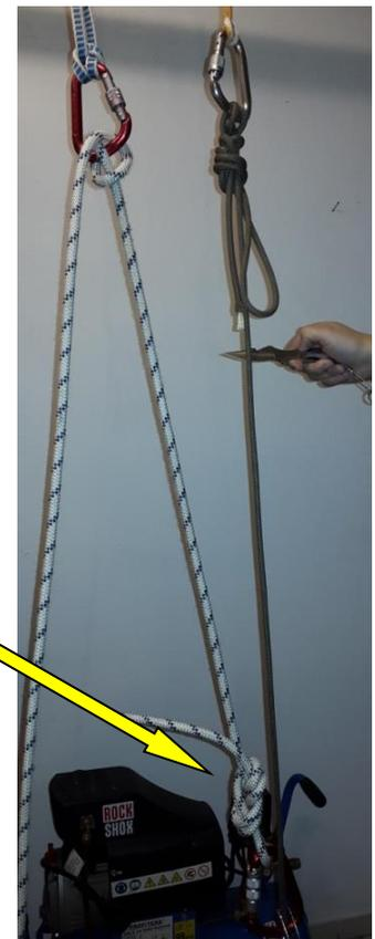
Wenn der Ti- Bloc so tief wie möglich angebracht wurde und im neuen System bereits eine kleine Vorspannung besteht ist der Ruck beim kappen (Lastübernahme von altem auf neues System) so gut wie nicht mehr zu spüren.
