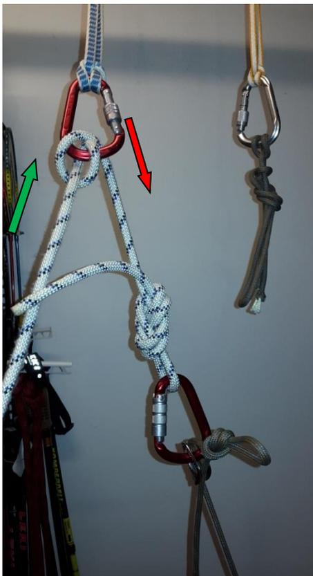
Nun kann der im Seil hängende SR oder die im Seil hängende Last über das neue System mit dem HMS passiv abgelassen werden.
