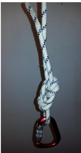
Am Ende des Seiles (neues System) knüpft der SR einen Verschlusskarabiner mit einer gesteckten Acht in das Seil ein.
